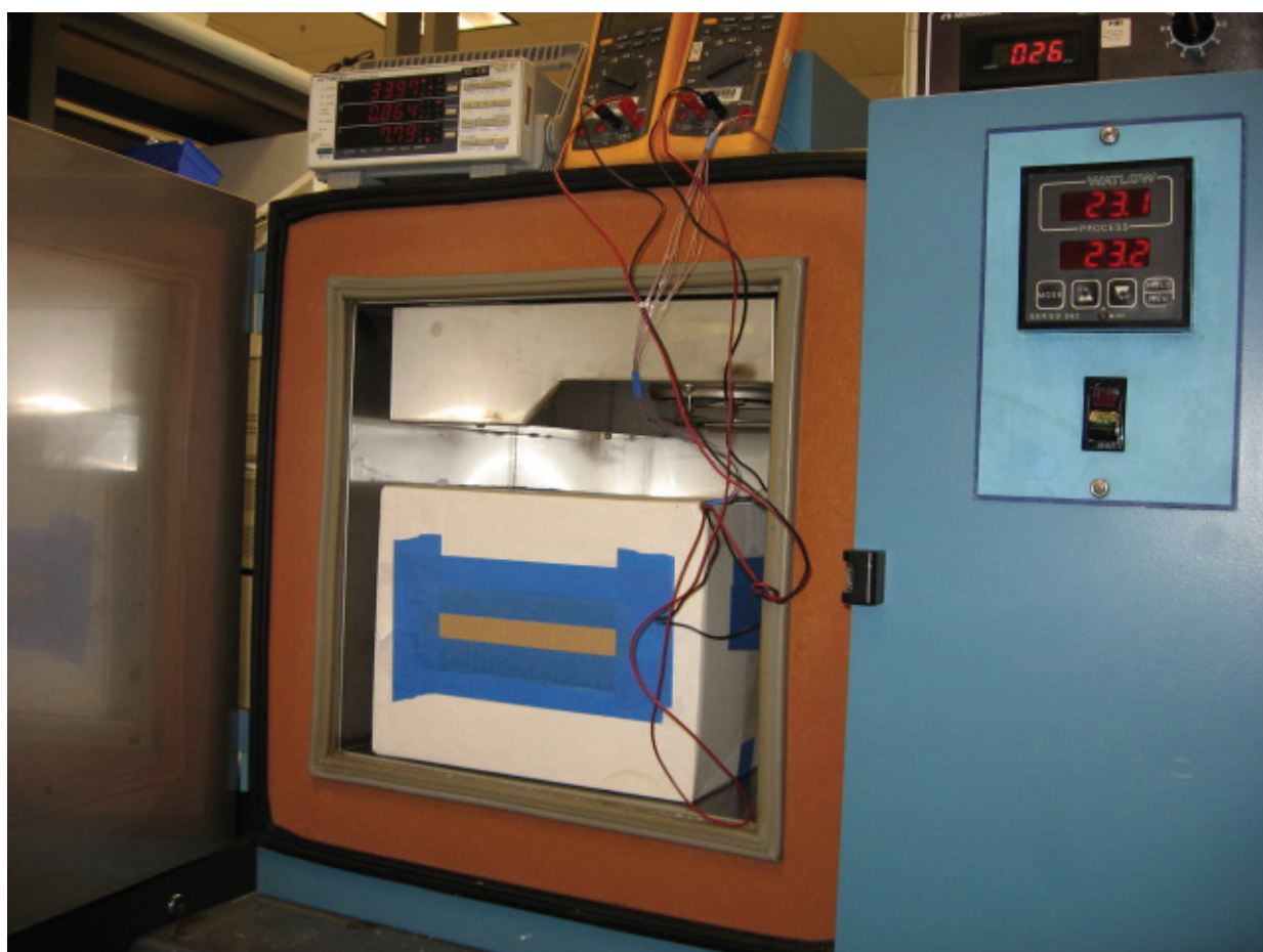
图18 – 用来防止气流通过被测电源的纸板箱所在的热处理室
